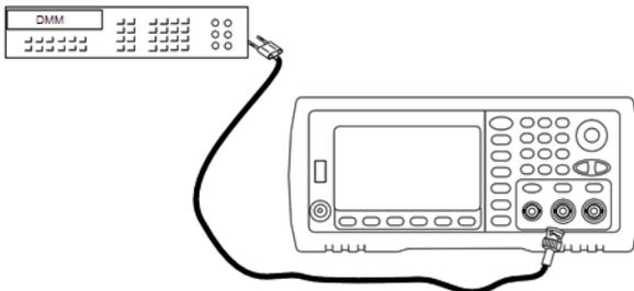
2. 계측기를 아래 표의 각 출력으로 설정하고 DMM을 사용하여 출력 전압을 측정합니다. 출력 임피던스를 High-Z로 설정하고 출력을 활성화하십시오.
