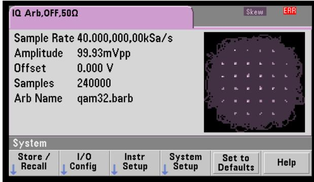
파형 이미지는 배치 다이어그램이지만 시간 영역 다이어그램으로 변경할 수 있습니다. 이렇게 하려면 **[System] > System Setup > Screen Layout**을 누르십시오. 그러면 다음 메뉴로 이동합니다.
