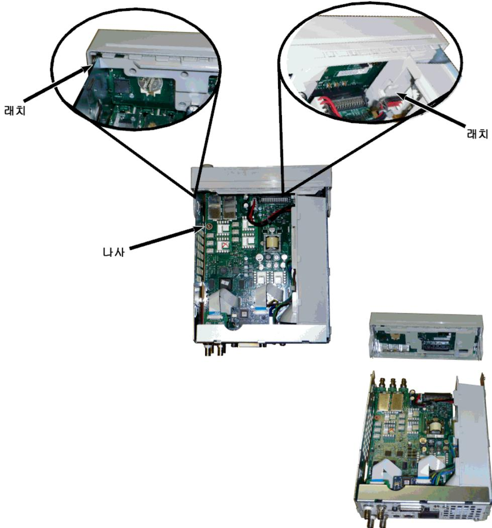
3. 메인 보드를(를) 제거합니다. 메인 보드에서 전원 공급기 커넥터 연결을 해제하고, **GPIB** 및 **Oscillator In** 리본 케이블 연결을 해제한 다음 메인 보드에서 팬 전원 케이블의 연결을 해제합니다. 그런 다음 **Modulation In** 및 **Ext Trig** BNC 커넥터를 후면 패널에 고정하는 너트를 풀어서 뺍습니다. 메인 보드를 새시에 고정하는 **GPIB** 보드 아래의 나사를 풉니다. 메인 보드를 계측기 앞쪽으로 밀어 전원 공급기 커버의 탭을 분리하고 메인 보드를 바깥쪽으로 들어올립니다.
