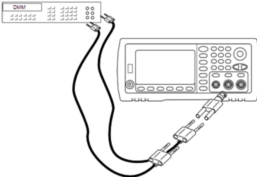
2. **DMM**을 사용하여 아래 표의 각 설정에 대해 전면 패널 출력 커넥터에서 4와이어 저항을 측정합니다. 예상 측정 값은 약 50Ω입니다.
