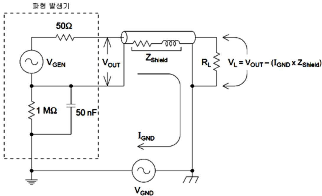
수 kHz 이상의 주파수에서 동축 케이블의 차폐는 저항성이 아닌 유도성을 띠며, 케이블이 변압기와 같은 작동을 하게 됩니다. 이러한 현상이 발생할 때  $I_{GND}$ 로 인한 차폐 내의 전압 강하가 중심 도체 내의 등가 전압으로 상쇄되어 높은 주파수에서 접지 루프의 영향이 감소됩니다. 이중 또는 삼중의 편조 차폐가 적용된 동축 케이블은 저항이 더 낮으며, 따라서 더 낮은 주파수에서 변압기 역할을 하게 되므로 단일 편조 또는 박막 차폐보다 훨씬 좋습니다.
