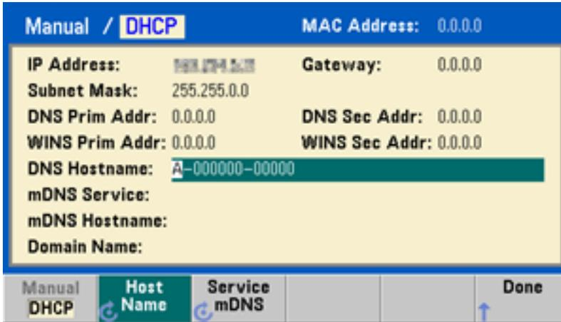
이 화면에 있는 대부분의 항목에 액세스하려면 첫째 소프트키를 사용하여 **DHCP**에서 **Manual**로 전환해야 합니다. DHCP 서버가 발견되었고 그러한 기능을 제공하는 경우, DHCP가 켜져 있으면 계측기를 네트워크에 연결할 때 DHCP(Dynamic Host Configuration Protocol)를 통해 IP 주소가 자동으로 설정됩니다. 또한 DHCP는 필요할 경우 서브넷 마스크와 게이트웨이 주소도 자동으로 처리합니다. 이 방법은 계측기에서 가장 쉽게 LAN 통신을 구축하는 방법입니다. DHCP를 켜기만 하면 됩니다. 자세한 내용은 LAN 관리자에게 문의하십시오.
