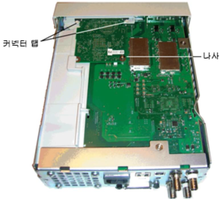
2. 전면 패널 어셈블리를 제거하고 메인 보드를 고정하는 T15 나사를 풀니다. 그런 다음 전면 패널 왼쪽의 래치와 전면 패널 오른쪽 전원 공급기 커버의 래치를 누릅니다. 금속 새시의 옆쪽을 가운데로 밀어 전면 패널 어셈블리 양쪽의 잠금쇠를 분리하고, 전면 패널 어셈블리를 새시에서 똑바로 조심스럽게 당깁니다. 전면 패널 어셈블리에는 메인 보드에 연결된 전기 커넥터가 있습니다. 커넥터가 손상되지 않도록 주의하십시오.
