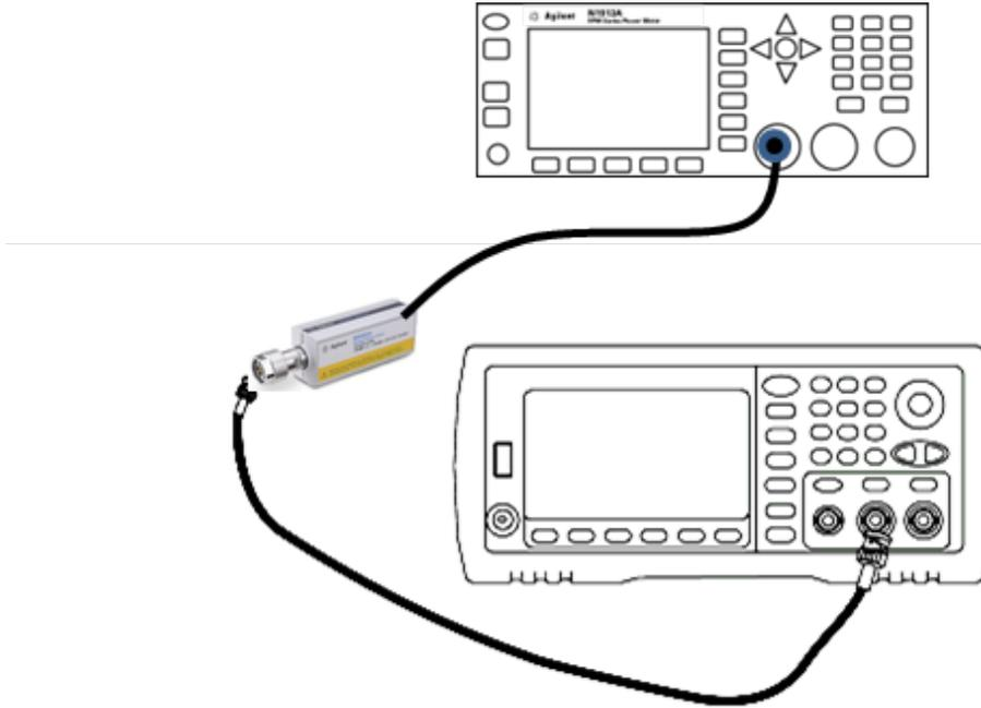
7. 보정 계수를 계산하려면 Fluke 5790A dBm 평균에서 전력계 dBm 평균을 뺍니다. 보정 계수 표의 오른쪽 하단에 이 결과를 기록합니다. 이 보정 계수를 모든 전력계 측정값에 추가합니다.
