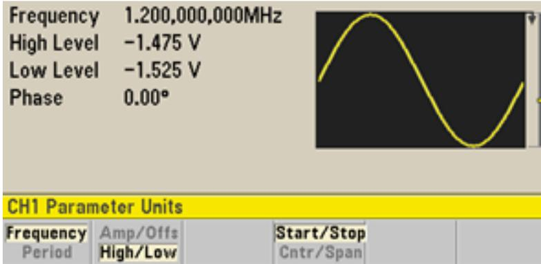
2. **[Parameters]** > **High Level**을 누릅니다. 숫자 키패드 또는 노브와 화살표를 사용하여 값으로 1.0V를 선택합니다. 키패드를 사용하는 경우 값을 입력하려면 **V** 단위 소프트키를 선택해야 합니다.
