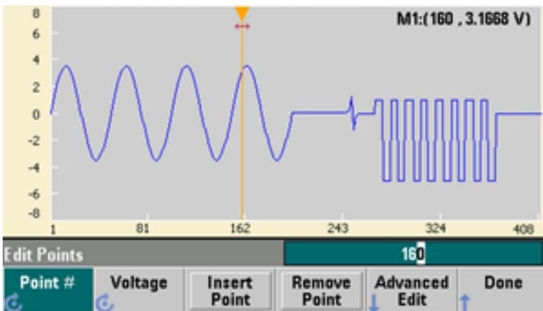
4. **Voltage**를 누르고 선택한 포인트의 전압을 4.2V로 변경합니다. **Point #**를 누르고 포인트 마커를 150으로 변경하여 마커를 포인트 밖으로 옮깁니다. **Enter**를 눌러 포인트 150의 입력을 완료하면 방금 포인트 160에 생성한 파형에 4.2V의 이상 현상이 있음을 확인할 수 있습니다.
