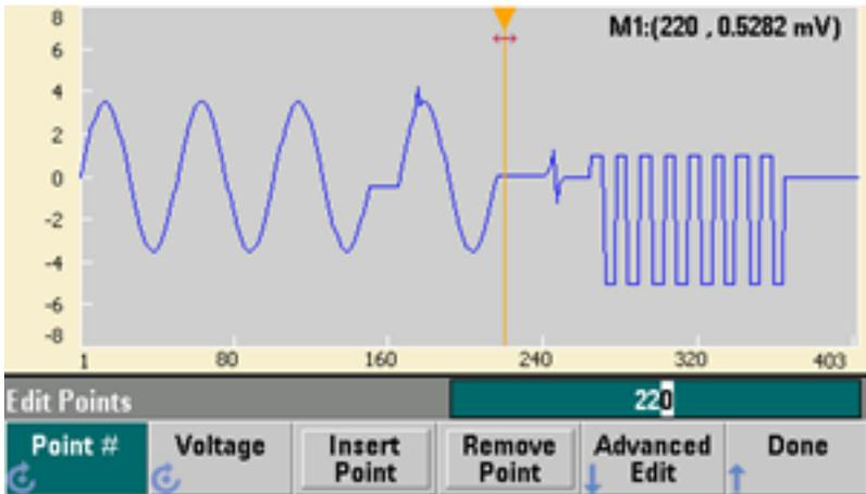
3. 또한 전압 표를 사용하여 포인트를 편집할 수 있습니다. **Advanced Edit > Edit Via Table**을 누릅니다. **Point #**를 200으로 설정하고 포인트 200의 **Voltage**를 3V로 설정합니다. 노브를 사용하여 행 사이를 이동하고 포인트 205 및 210의 **Voltage**를 3V로 설정한 다음 **Done**을 누릅니다.
