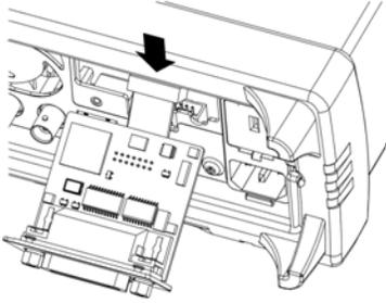
5. 모듈을 기기 안에 넣고 GPIB 보드를 오른쪽으로 밀어서 계측기의 판금과 수평을 이루도록 합니다. 위에서 제거한 나사를 사용하여 GPIB 판을 제자리에 고정시킵니다.
