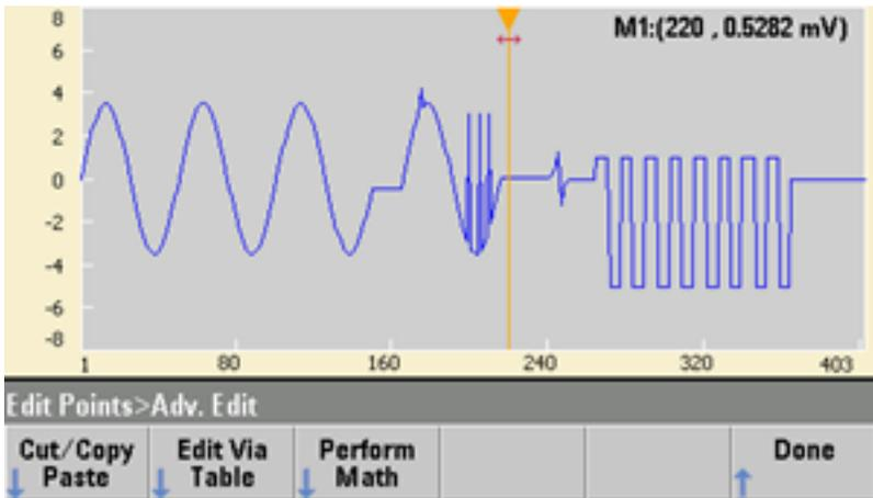
5. **Cut/Copy Paste**를 누르고 **Marker 1**을 150으로 설정합니다. 그런 다음 첫째 소프트키를 눌러 **Marker**를 **Marker 2**로 변경합니다. **Marker 2**를 300으로 설정합니다. 마커에 의해 정의되는 범위가 이제 검은색으로 강조 표시됩니다.
