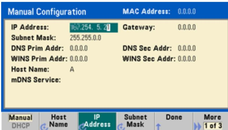
사용해야 하는 IP 주소, 서브넷 마스크 및 게이트웨이는 네트워크 관리자에게 문의하십시오. 모든 IP 주소에는 "nnn.nnn.nnn.nnn" 형식의 도트 표기가 사용되며 여기서 각 "nnn"은 0~255 범위의 바이트 값입니다. 숫자 키패드를 사용하여 새 IP 주소를 입력할 수 있으며 노브는 사용할 수 없습니다. 키패드를 사용하여 숫자와 마침표 구분 문자를 입력하면 됩니다. 왼쪽 커서 키가 백스페이스 키로 사용됩니다. **선행 0은 입력하지 마십시오.**
