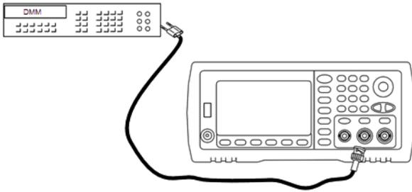
2. 계측기를 아래 표의 각 출력으로 설정하고 DMM을 사용하여 출력 전압을 측정합니다. 출력 임피던스를 High-Z로 설정하고 출력을 활성화하십시오.
