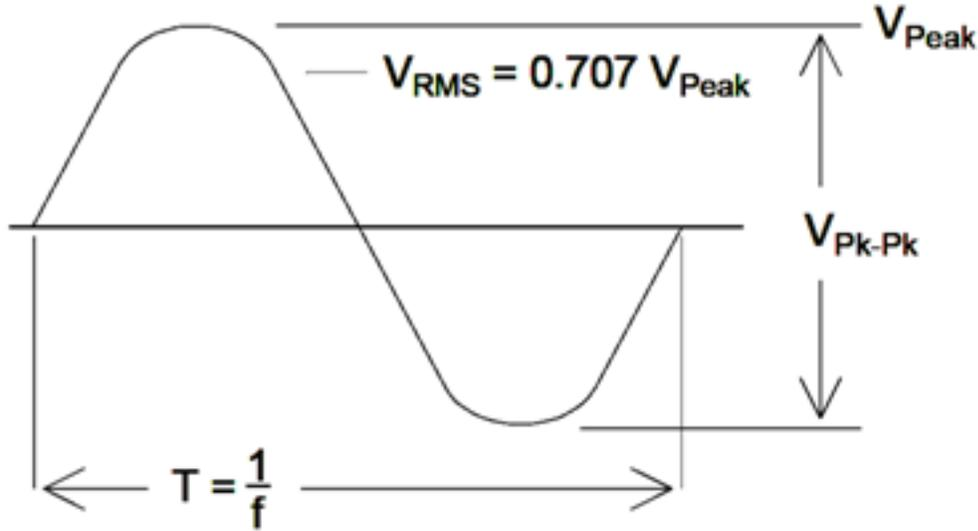
파형의 피크 전압은 모든 포인트의 최대 절대값입니다. 피크 대 피크 전압은 최대값과 최소값의 차이입니다. RMS 전압은 모든 파형 포인트의 표준 편차와 같으며, 신호에 포함된 1 사이클 평균 출력에서 신호의 DC 성분 내 출력을 뺀 값을 나타내기도 합니다. 파고율은 RMS 값에 대한 신호의 피크 값 비율이며, 파형 형태에 따라 변화합니다. 아래 표에 몇 가지 일반적인 파형과 각각의 파고율, RMS 값이 나와 있습니다.
